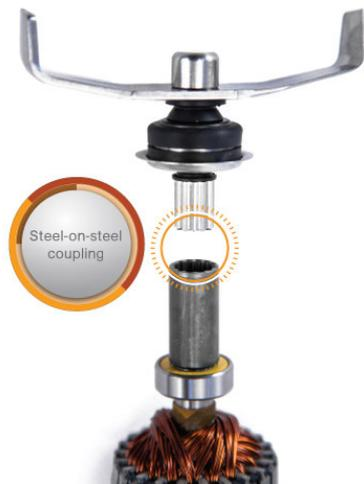
dazwischenliegenden Teile sind aus Stahl, hochpräzise hergestellt für beste Passgenauigkeit. Diese Stahl-auf-Stahl Verkopplung verringert die Vibration, ist geräuschärmer und erhöht die Zuverlässigkeit.
