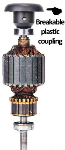
In vielen anderen Mixern führt die Leistung vom Motor durch eine anfällige Kunststoffkupplung. Die Kupplung ist so konzipiert, dass sie bricht um den Motor bei Überlastung zu schützen. Diese Konstruktionsart führt leider dazu, dass die Leistung und die Lebensdauer der Kupplung begrenzt wird.
